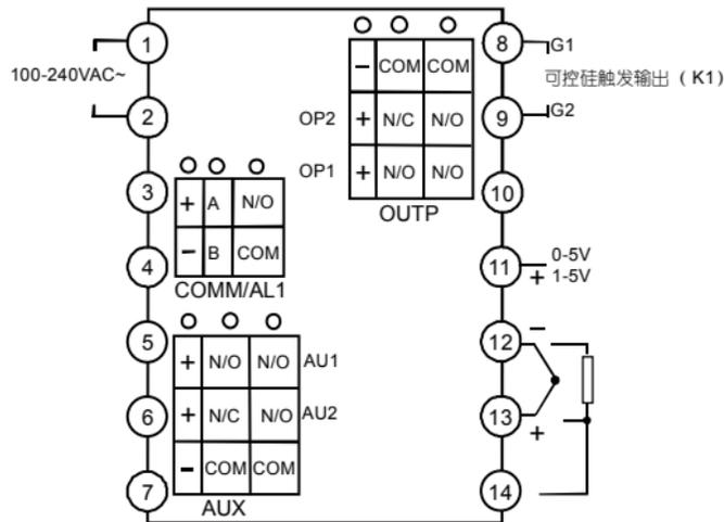
注1：线性电压量程在500mV以下的由13、12端输入，0~5V及1~5V的信号由11、12端输入。
